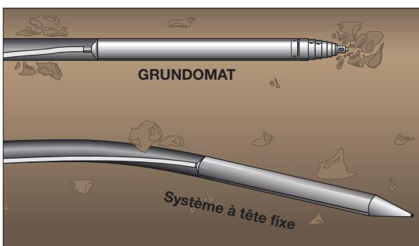
**En conséquence:** Le fonctionnement en deux étapes fait que la GRUNDOMAT est plus précise qu'un système à tête fixe. L'énergie de frappe est transmise de manière optimale à l'endroit où elle est nécessaire.
