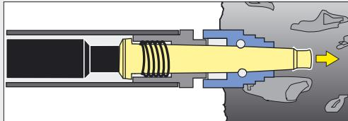
Dans la première étape le burin frappe. La tête à arêtes avance, détruit les obstacles et effectue le forage (forage pilote).
