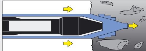
**Effet:** L'énergie de frappe n'est pas transmise précisément, il y a une perte d'énergie. D'un autre côté, ce système nécessite une énorme énergie de frappe pour surmonter la résistance et le frottement de la terre en même temps. La vitesse un peu plus élevée va au détriment de l'exactitude et de la stabilité directionnelle.
